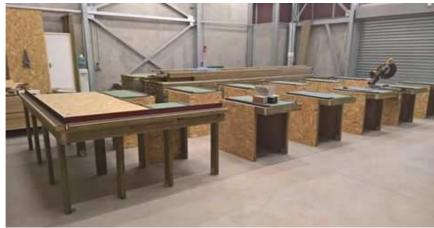
Elles nous permettent d'assembler les lisses basses, hautes, les montants et le voile travaillant.
