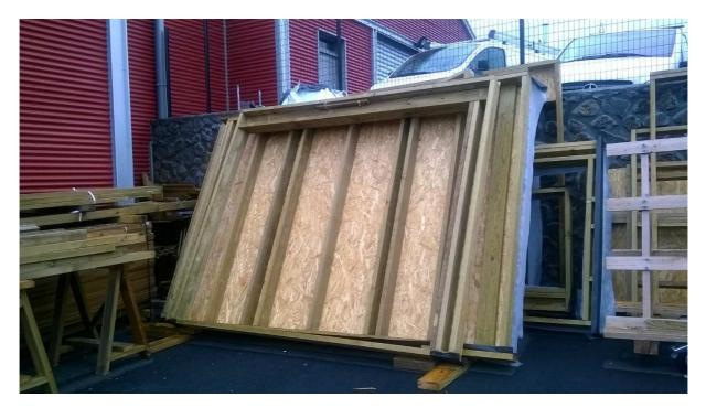
L'ossature bois est une technique qui consiste à assembler des montants verticaux et des traverses horizontales pour former des cadres en bois massif. Les éléments sont fabriques selon les normes les plus exigeantes
