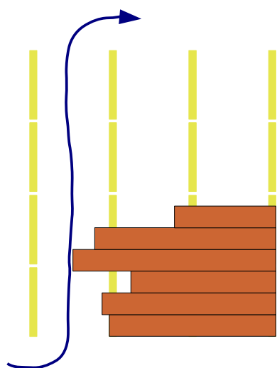
Figure 11 – Lame d'air en pose horizontale
